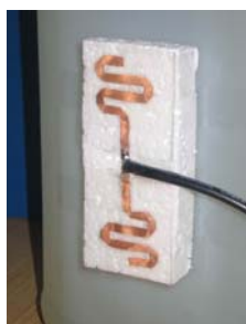
Obr. 2.1 – Meandrově zkrácený půlvlnný dipól (umístěný na polystyrenové podložce tloušťky 20 mm)
