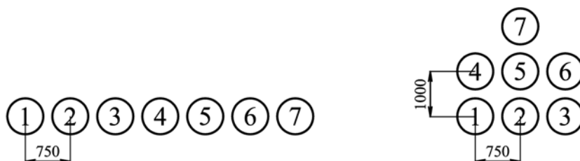
Obr. 7.2 – Základní formace závodníků pro testování RFID systému
